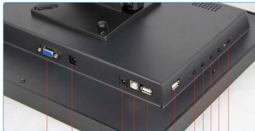
ENTRADA VGA ENTRADA DC (CORRIENTE CONTINUA) ENTRADA DC USB TÁCTIL ENTRADA DE USB SALIDA DE USB MENÚ ARRIBA ABAJO ENCENDIDO INTRO
